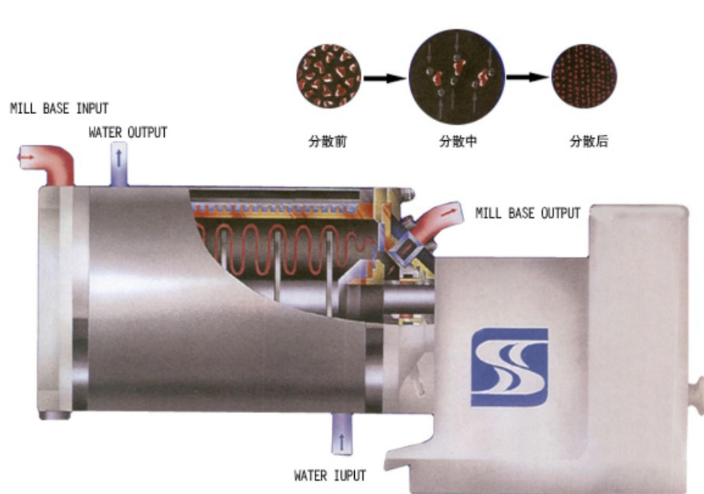
卧式砂磨机是一种水平湿式连续性生产之超微粒分散机，其操作方法系利用高粘度泵浦如齿轮泵浦等，将预先搅拌妥原料送入主机之研磨槽，研磨槽内填充适量之分散研磨媒体，如玻璃珠等经由分散叶片高速转动，赋予研磨媒体足够之动能，与被分散之颗粒冲击产生剪力，达到分散效果，再经由特殊之分离装置，将被分散物与研磨媒体分离排出。因为不必像三滚筒一样需要高度的操作技巧，即可得到均一而优良的品质，又可大量连续生产，因此即可提高品质又可降低成本，亦可适用于高粘度物质之分散，因之对油漆、油墨、染料、修正液、化妆品、农药、电子、造纸等工业均可适用。
